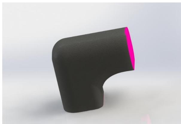
Figura 06: Modelo 3D da cabeça auxiliar de direcionamento de ar.
