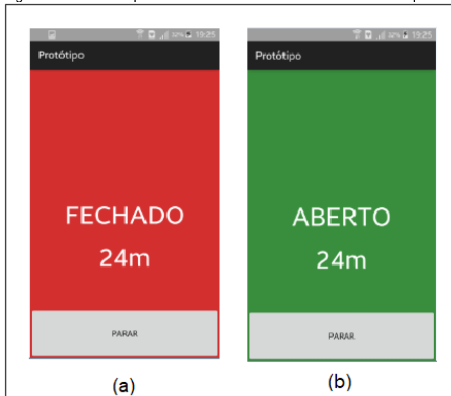
Figura 14 – Tela do aplicativo retornando os status do semáforo de pedestres
