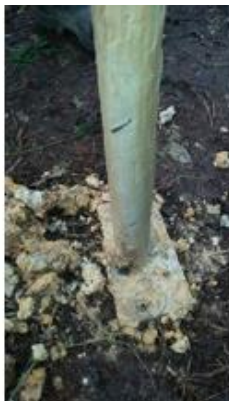
Figura 9 - Execução de sondagem a trado manual com coleta/ recuperação do testemunho (argilas)
