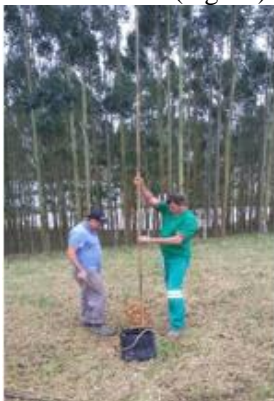
Figura 9 - Execução de sondagem a trado manual com coleta/ recuperação do testemunho (argilas)
