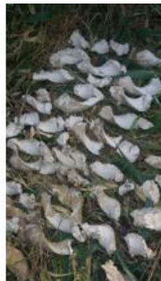
Figura 9 - Execução de sondagem a trado manual com coleta/ recuperação do testemunho (argilas)
