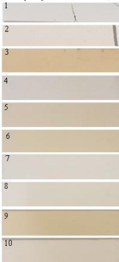
Figura 41 - Corpos de prova após a queima (Misturas 1 a 10, de acordo com o planejamento de misturas).
