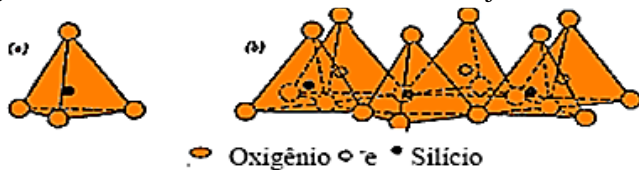
Figura 3 - Tetraedro de sílica isolado e rearranjado de forma hexagonal
