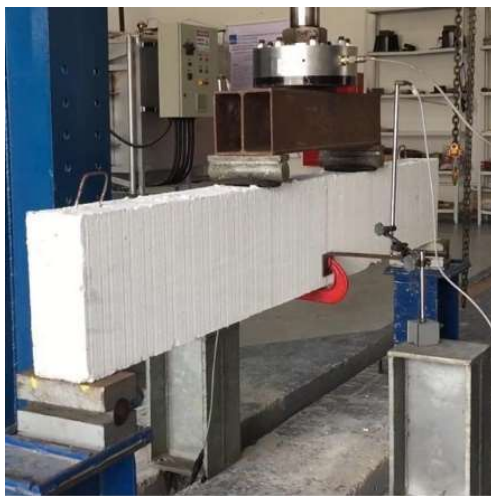
Figura 7: Ensaio de flexão a 4 pontos
