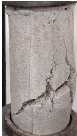
Figura 12 – Corpo de prova com concreto geopolimérico a 800 °C
