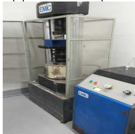
Figura 13 - Equipamento utilizado para ensaio Push-in
