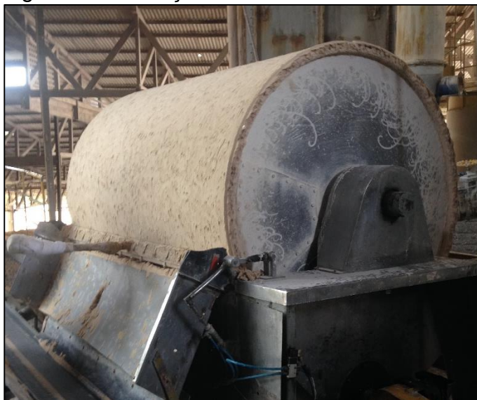
Figura 5 – Ilustração de filtro de tambor a vácuo localizado na empresa.
