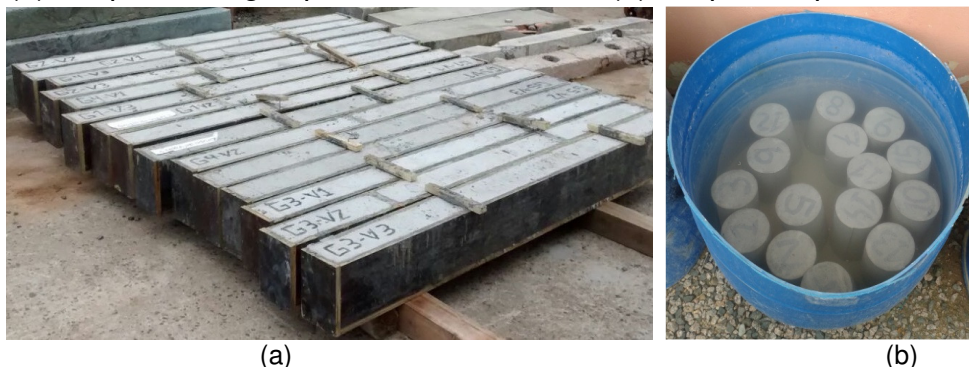
Figura 4:(a) Grupos de Vigas para ensaio a flexão, (b) Corpos de prova.
