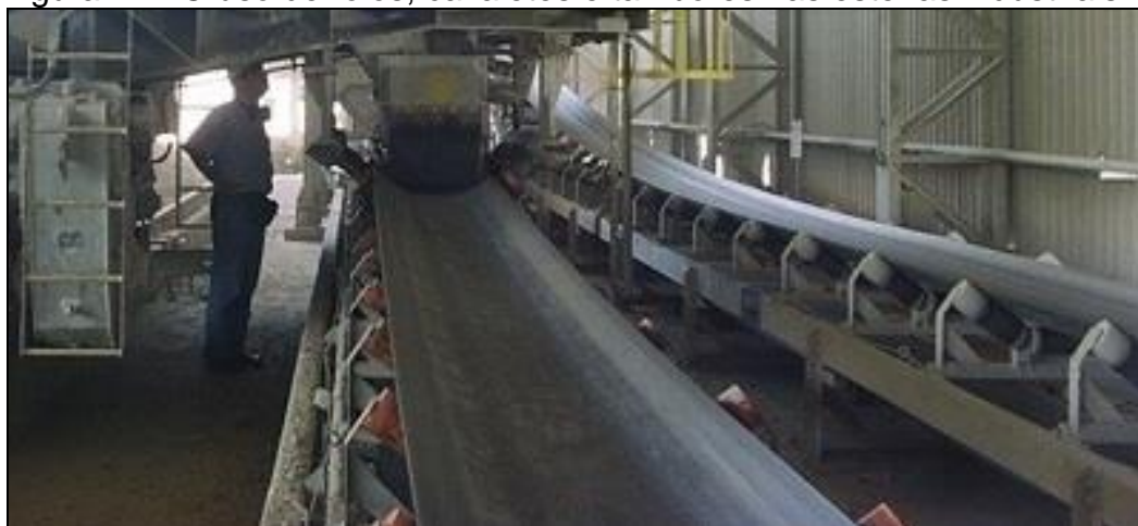
Figura 11 - O uso de rolos, cavaletes e tambores nas esteiras industriais.
