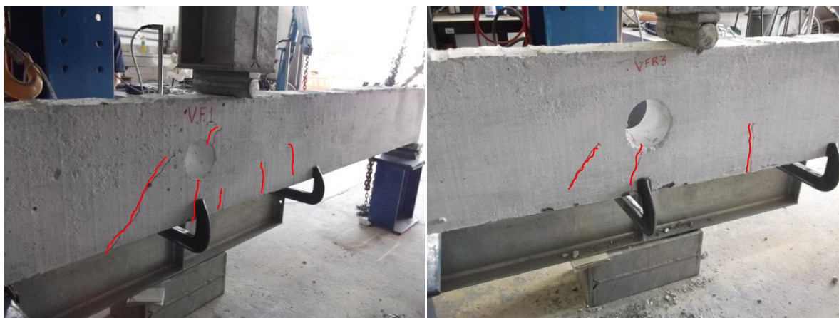
Figura 16 – Comparação de fissuras no ELU das vigas furadas (grupo 2) e vigas furadas com reforço (grupo 3)
