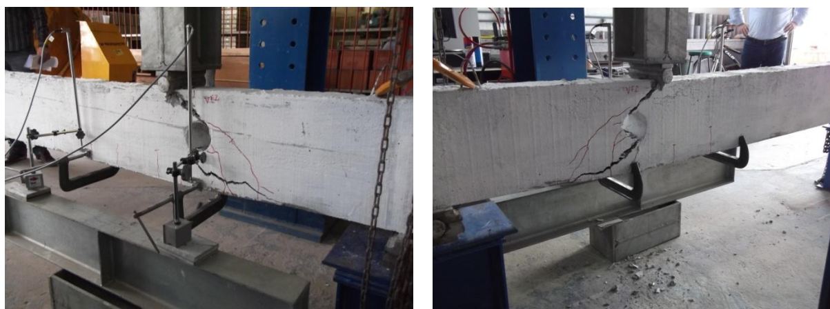
Figura 13 – Forma de ruptura das vigas
