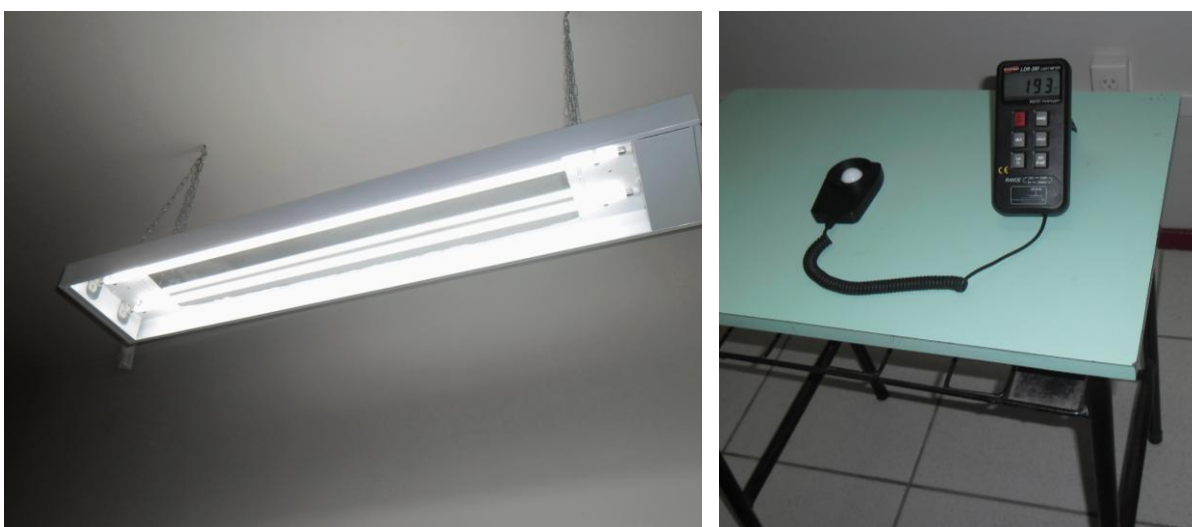
Figura 13: Medições com lâmpada T5 28W e luminária com fundo transparente
