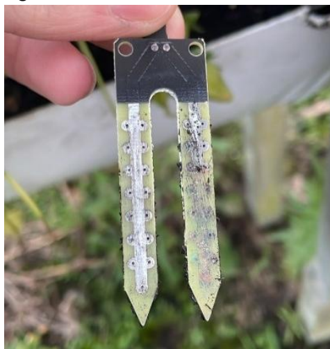
Figura 4 - Sensor resistivo oxidado
