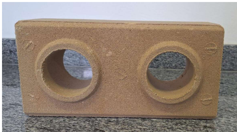
Figura 11 - Imagem fotográfica representativa de um tijolo de solo-cimento obtido por processamento industrial, na empresa parceira.
