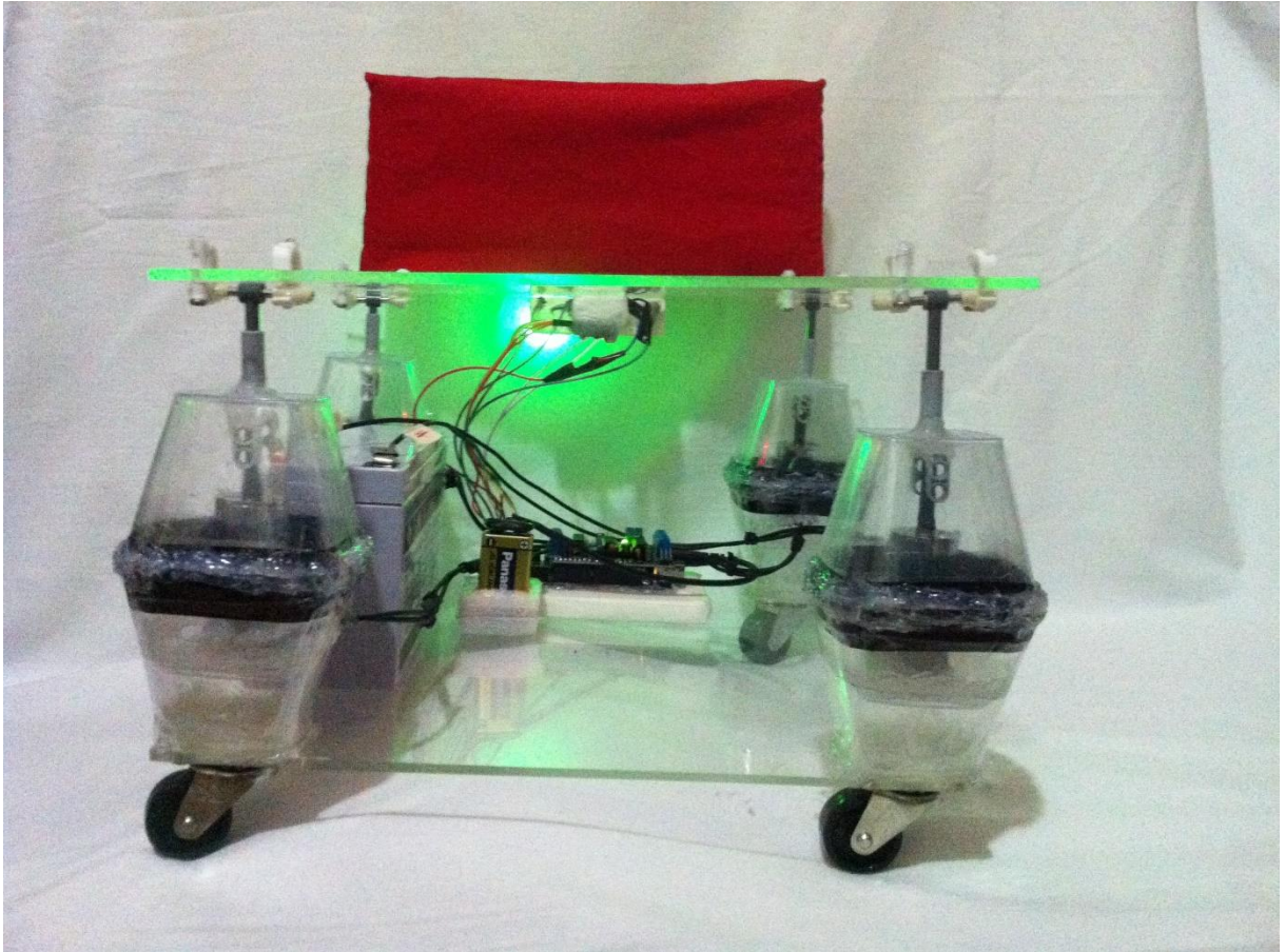
Apêndice B – Protótipo da cadeira de rodas, sendo aplicado nivelamento no eixo X
