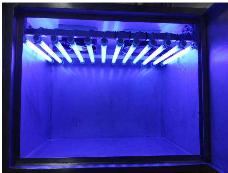
Figura 8. Câmara de radiação ultravioleta utilizada no ensaio de fotocatalise sob irradiação UV.
