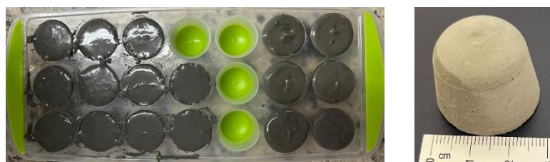
Figura 9 – Molde e corpos de prova para ensaio em pasta de ATD/TG e DRX.
