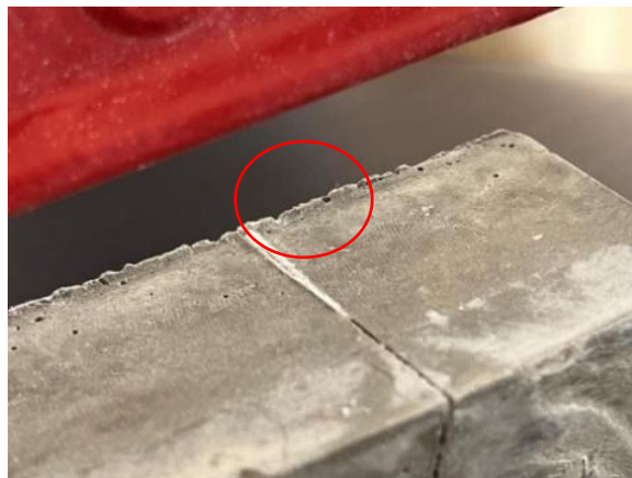
Figura 38 – Formação de produtos de hidratação com grande volume em CAF.
