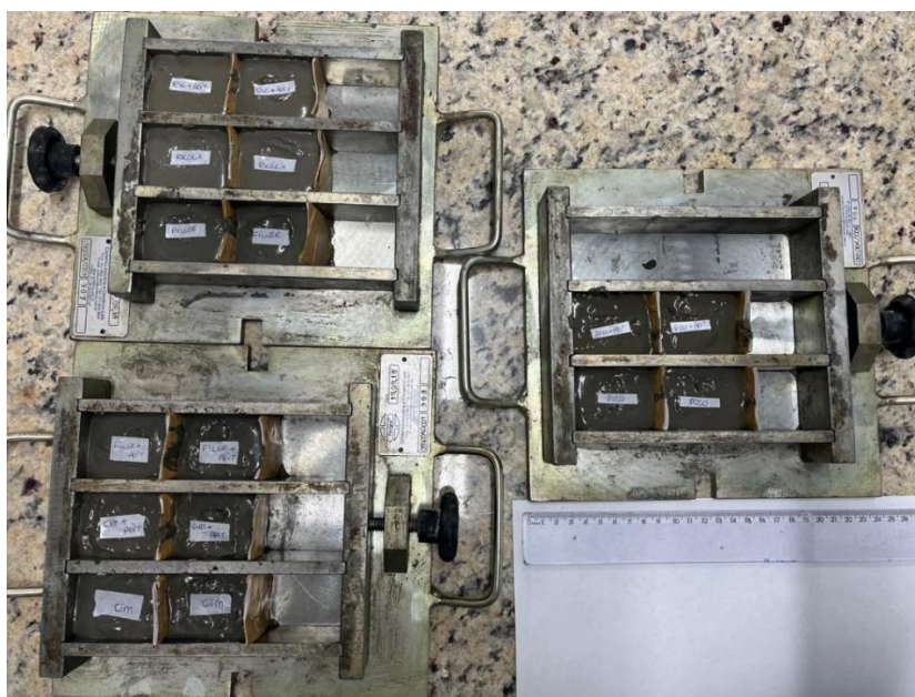
Figura 11 – Moldagem dos corpos de prova para ensaios de desempenho das misturas cimentícias.
