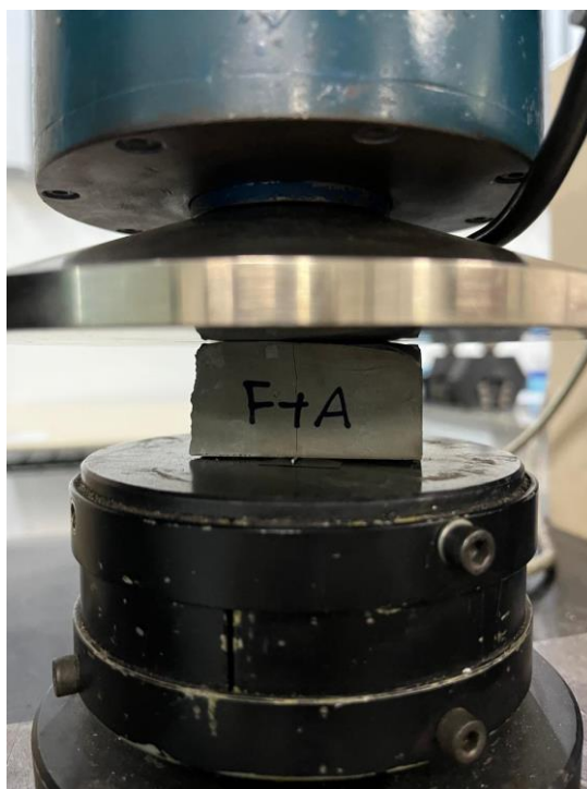
Figura 12 – Fissuração da amostra em máquina de ensaio universal, com célula de carga de 10 ton e fixação de haste metálica na face inferior da amostra.
