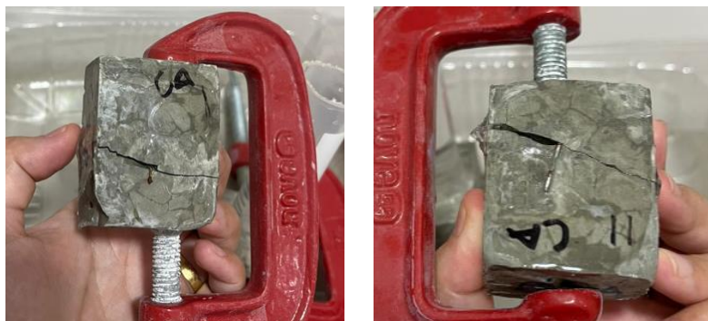
Figura 41 – Imagens mostrando em detalhe a fissura com quebra nas bordas na face inferior das amostras de CA.
