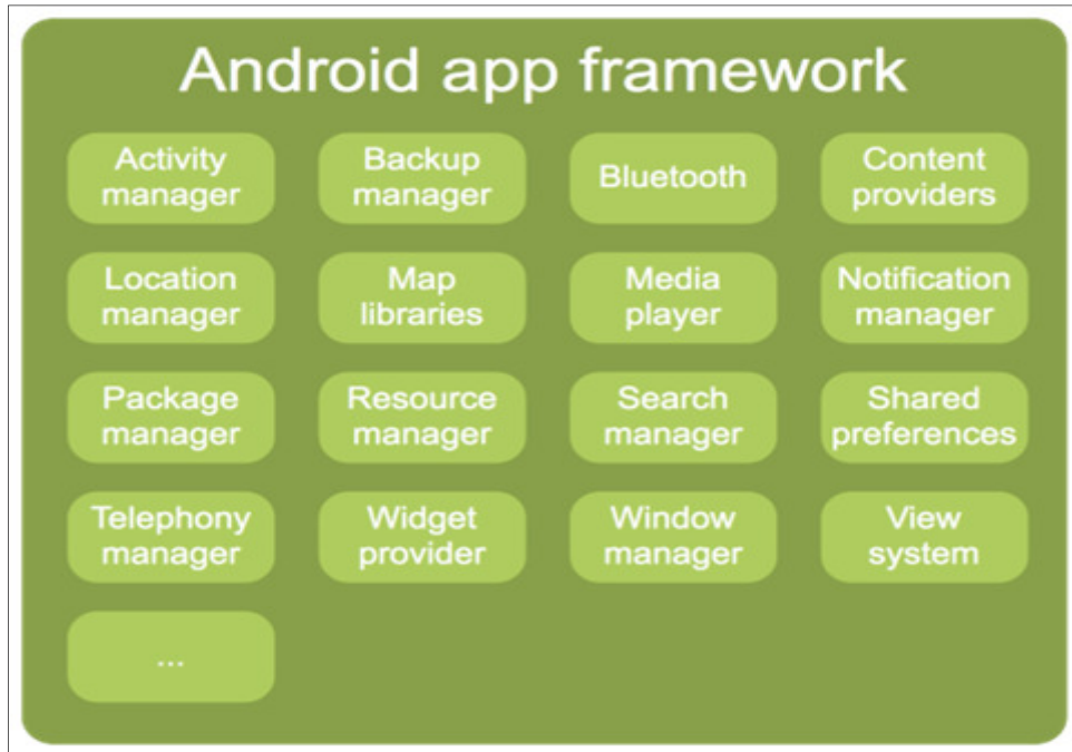
Figura 2 – Camada de Framework do Android
