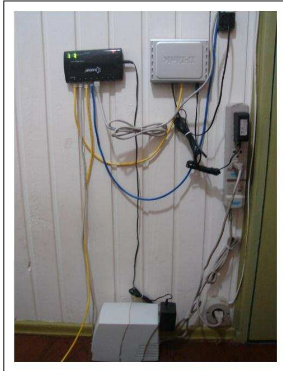
Figura 35. Estrutura de compartilhamento da Internet via ADSL
