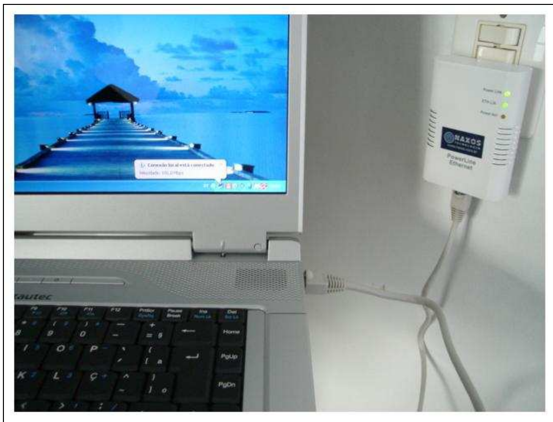
Figura 60. Conexão com o adaptador PLC no hall do edifício Orion
