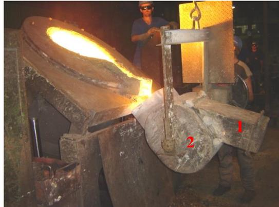
Figura 15– Vazamento da liga para a panela de nodularização fonte:Produção da Metalúrgica Riosulense
