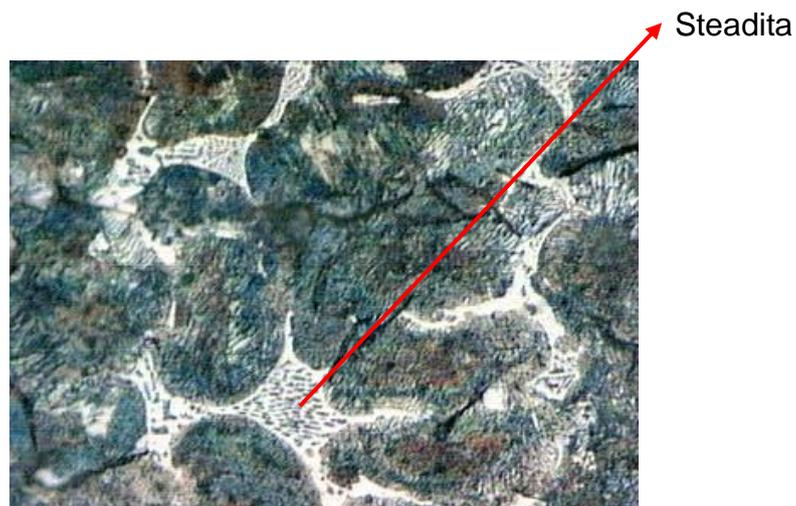
Figura 7: Micrografia evidenciando a Steadita. Ataque nital 3%. 500X. Fonte: O autor
