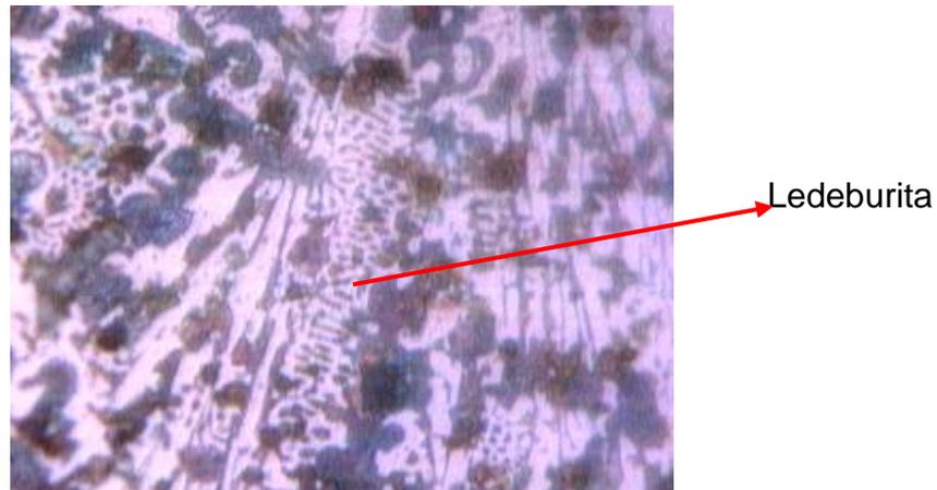
Figura 6: Micrografia evidenciando a Ledeburita. Ataque nital 3%. 500X. Fonte: O autor
