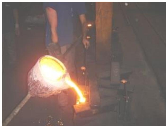
Figura 23 : Técnica de pós inoculação. Fonte: produção da Metalúrgica Riosulense SA
