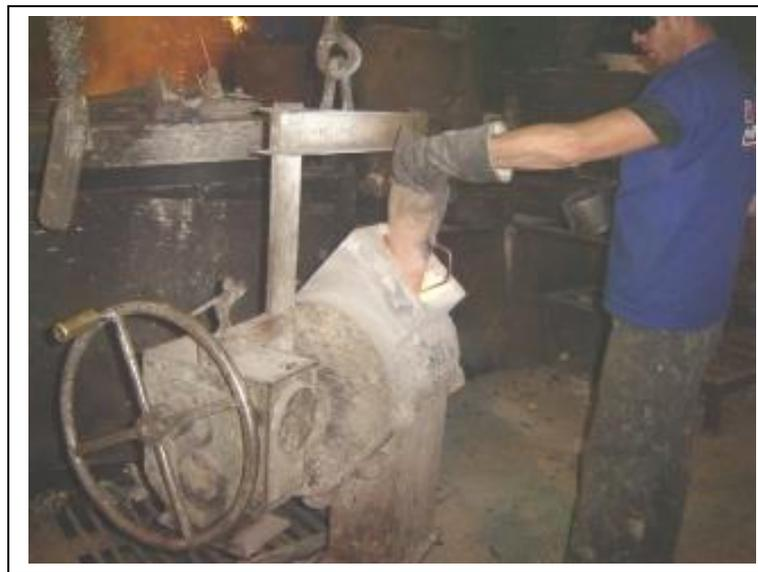
Figura 21: Inserção da liga nodularizante no fundo da panela de nodularização. Fonte: produção da Metalúrgica Riosulense SA
