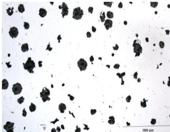
Figura 8: Grafita irregular. Sem ataque. 100X. Fonte: ELKEN ASA, Foundry Products Division. De acordo com a Norma EN ISO 945.
