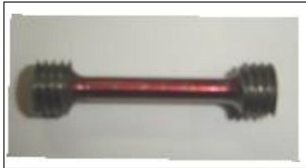
Figura 24 :Corpo de prova utilizado para tração.Fonte: Produção da Metalúrgica Riosulense SA
