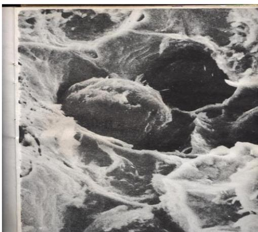
Figura 13: Fotografia de nódulo de grafita obtida em microscópio eletrônico de varredura. 1600X. Fonte (Adalberto,B de S.S; Carlos, H.C.B ,1977, p.175)
