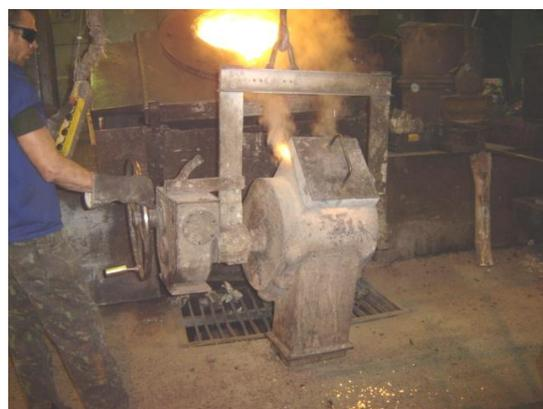
Figura 16 – Reação de nodulização dentro da panela.Fonte: Produção da Metalúrgica Riosulense
