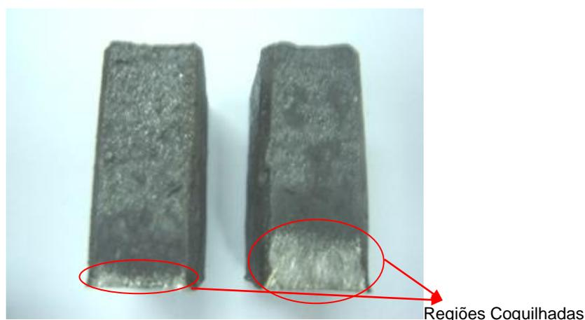
Figura 20: Diferença de coquilhamento após e antes da correção do banho. Fonte: produção da Metalúrgica Riosulense
