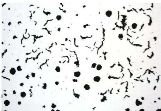
Figura 9: Grafita vermicular. Sem ataque. 200X. Fonte: ELKEN ASA, Foundry Products Division. De acordo com a Norma EN ISO 945.
