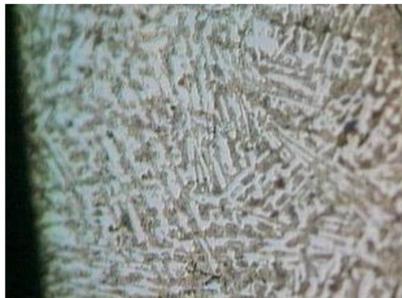
Figura 3: Agulhas de Cementita. Ataque Nital 3,5% 100X. Fonte: O autor
