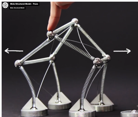
Figura 5: Modelo qualitativo Mola Structural Model simulando aplicação de carga Fonte: Disponível em < https://br.molamodel.com/pages/info >.
