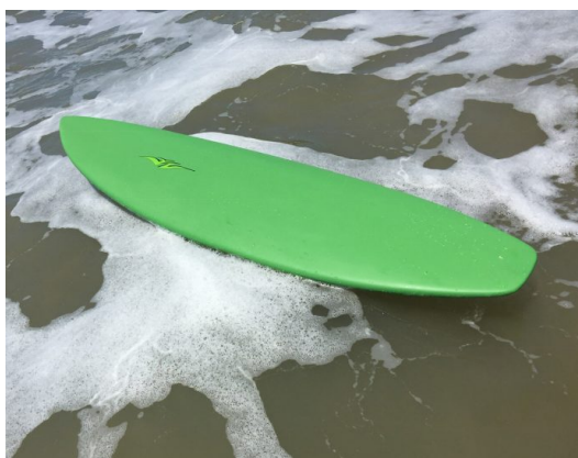
Figura 1 - Prancha de surf desenvolvida com resina de mamona .
